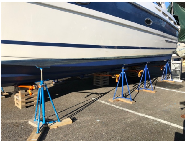
Solide kjølstøtter og godt dimensjonert trevirke under sidestøtter
