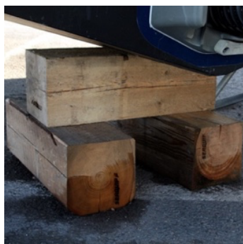
Kjølstøtte motorbåt Min. 4"x 4" trevirke
